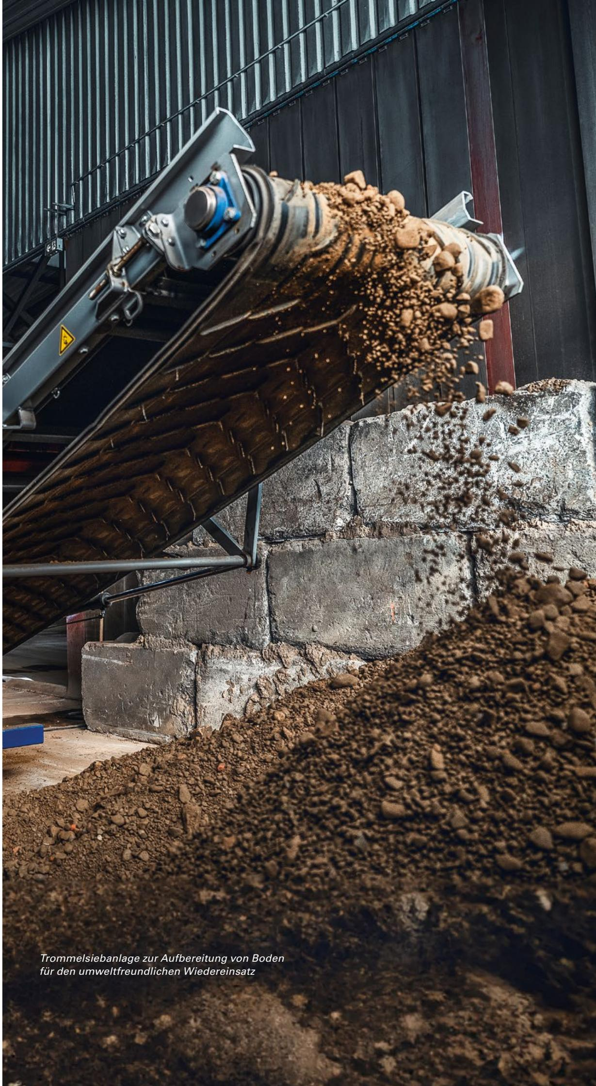
*Trommelsiebzanlage zur Aufbereitung von Boden
