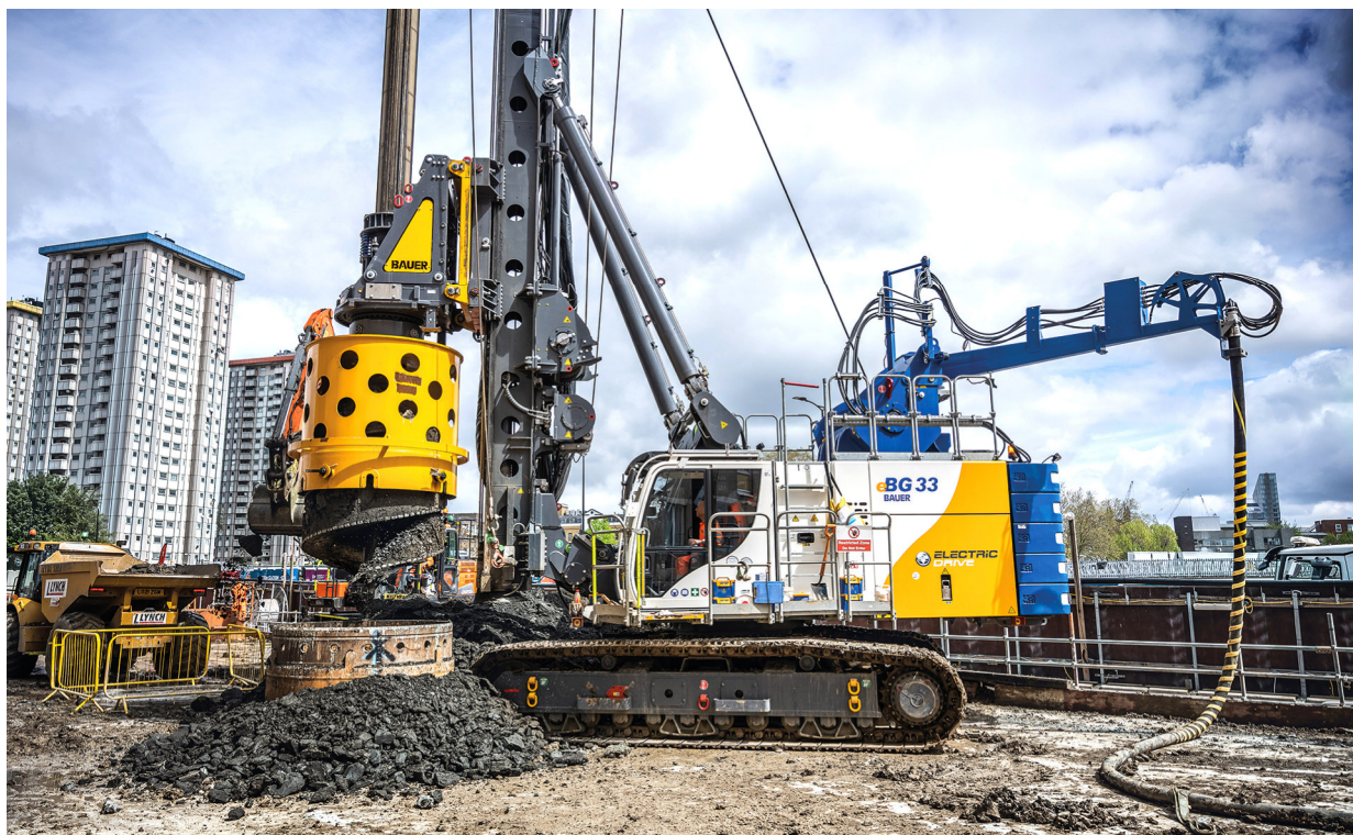
Die eBG 33 ist das weltweit erste elektrische Großdrehbohrgerät von Bauer.
