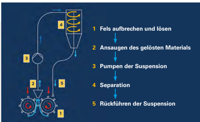
Der Ansatz basiert auf der Frästechnik. Das gewonnene Material wird direkt am Meeresboden separiert.
