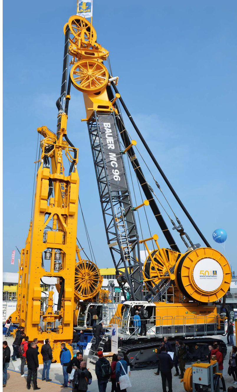
Auf der Bauma 2019 in München präsentierte die BAUER Maschinen GmbH erstmals eine elektrisch angetriebene Fräse auf Basis eines Bauer-Seilbaggers.
