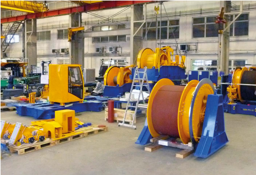
In der Fertigungshalle werden die einzelnen Komponenten zu Winden zusammengefügt (links). Der Förderhaspel SBN FH-55 kann mittels Modulfahrwerk transportiert werden (unten).
