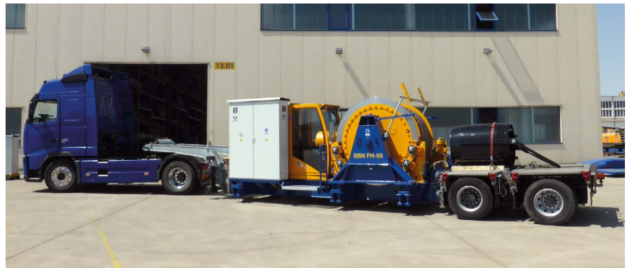
In der Fertigungshalle werden die einzelnen Komponenten zu Winden zusammengefügt (links). Der Förderhaspel SBN FH-55 kann mittels Modulfahrwerk transportiert werden (unten).
