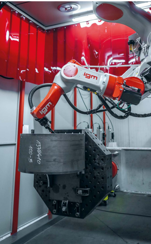
In der 10 x 10 m großen Roboterzelle können bis zu 2 m lange und 2 t schwere Bauteile geschweißt werden (oben), während der Schweißroboter mittels Tablet programmiert und gesteuert wird (rechts).
