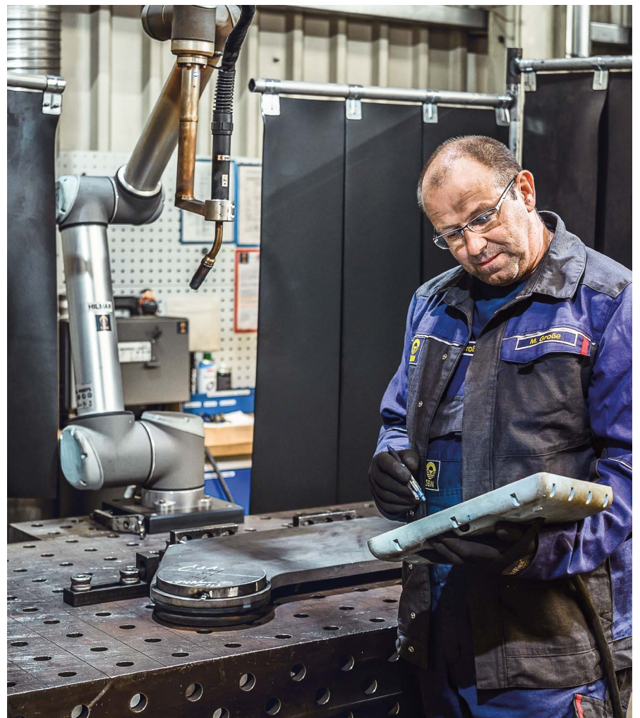
In der 10 x 10 m großen Roboterzelle können bis zu 2 m lange und 2 t schwere Bauteile geschweißt werden (oben), während der Schweißroboter mittels Tablet programmiert und gesteuert wird (rechts).
